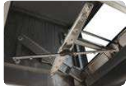
Górne ramiona do mycia i płukania.
